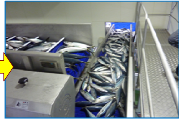
コンベアで搬送しながら自動計量
