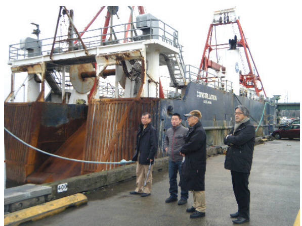
図Ⅶ.3-5 カレイ類、タラ、赤魚等の底魚を漁獲、船内にてH&G加工&冷凍するファクトリートローラー、150フィート、2500HP、クルー30-40名（内訳（目安）：ブリッジ2-3、デッキ4-6、エンジニア2、ファクトリー20-25）
