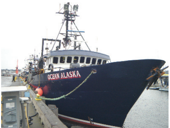
図Ⅶ.3-6 カレイ類、タラ、赤魚等の底魚を漁獲、船内にてH&G加工&冷凍するファクトリートローラー、107フィート、1500HP、クルー20名（内訳（目安）：ブリッジ2、デッキ4-5、エンジニア2、ファクトリー10-12）
