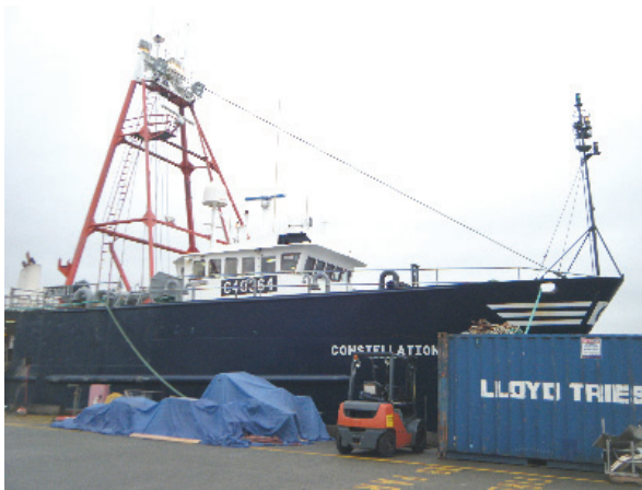
図Ⅶ.3-5 カレイ類、タラ、赤魚等の底魚を漁獲、船内にてH&G加工&冷凍するファクトリートローラー、150フィート、2500HP、クルー30-40名（内訳（目安）：ブリッジ2-3、デッキ4-6、エンジニア2、ファクトリー20-25）
