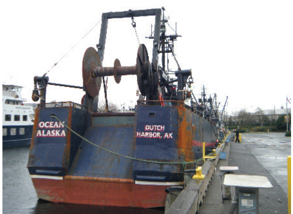
図Ⅶ.3-6 カレイ類、タラ、赤魚等の底魚を漁獲、船内にてH&G加工&冷凍するファクトリートローラー、107フィート、1500HP、クルー20名（内訳（目安）：ブリッジ2、デッキ4-5、エンジニア2、ファクトリー10-12）
